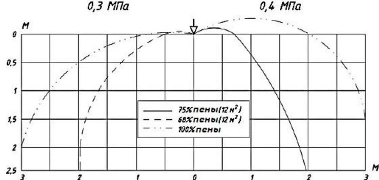
**График зависимости интенсивности орошения от давления на площади 12 м<sup>2</sup>, защищаемой одним оросителем с высоты 2,5 м**
