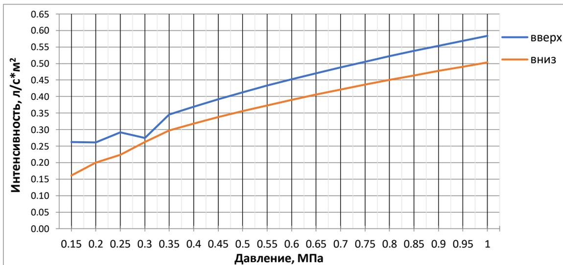
**График зависимости интенсивности орошения от давления на площади 12 м<sup>2</sup>, защищаемой группой оросителей (два и более) с высоты 2,5 м**
